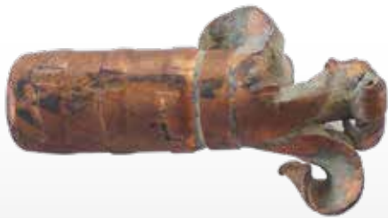
Deformiertes Geschoss LFB COMPACT
