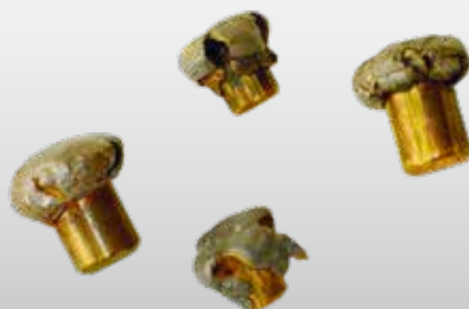
Deformierte Geschosse LFB SOLID SM TMS HP und SM TMR
